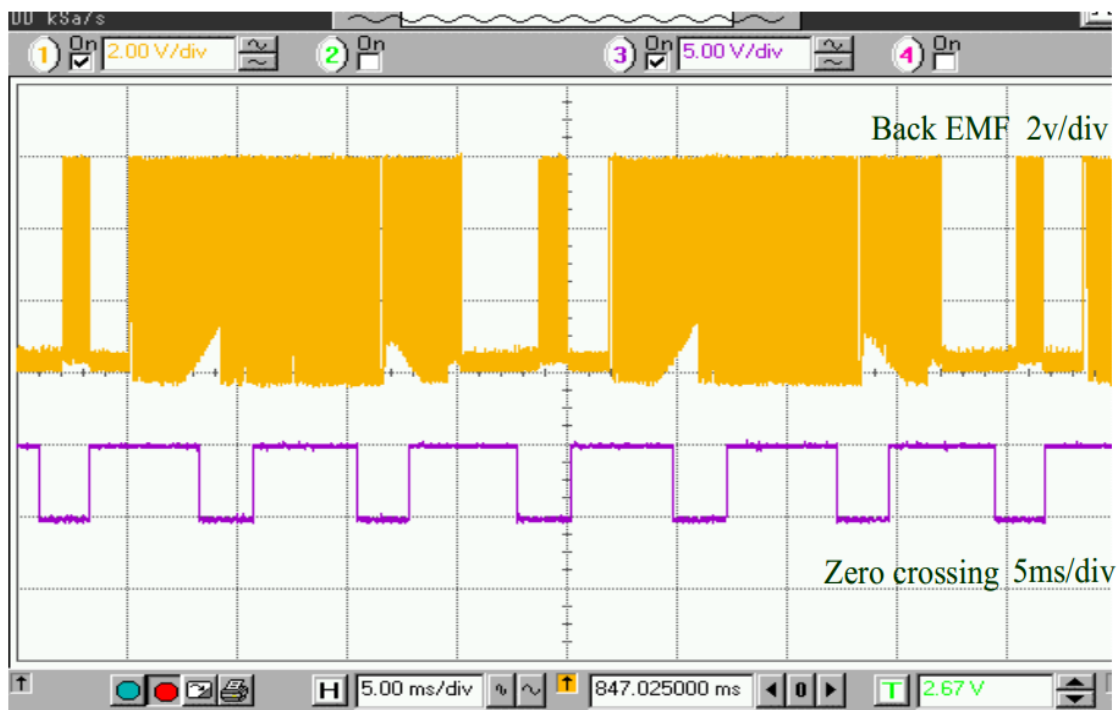
Hình.3.4: Kết quả thử nghiệm cắt EMF zero ở tốc độ thấp.
