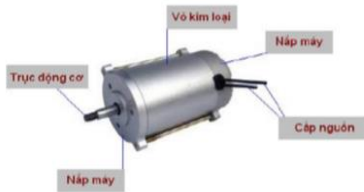
Hình 2.1 cấu tạo bên ngoài của động cơ điện một chiều
