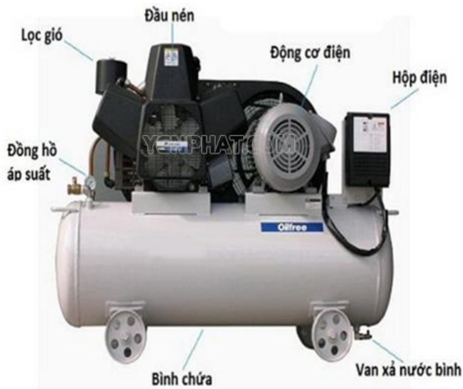
Hình 2.1 : Cấu tạo cơ bản của máy nén khí piston
