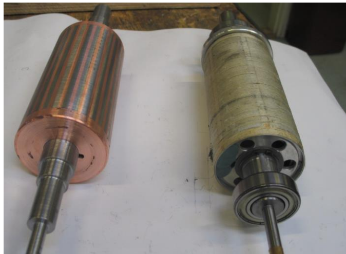
Hình 3.5. Cánh quạt của hai loại động cơ được sử dụng trong nghiên cứu này
