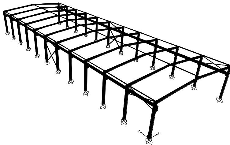
Hình 3.15: Sơ đồ khung không gian không có xà gồ và giằng mái
