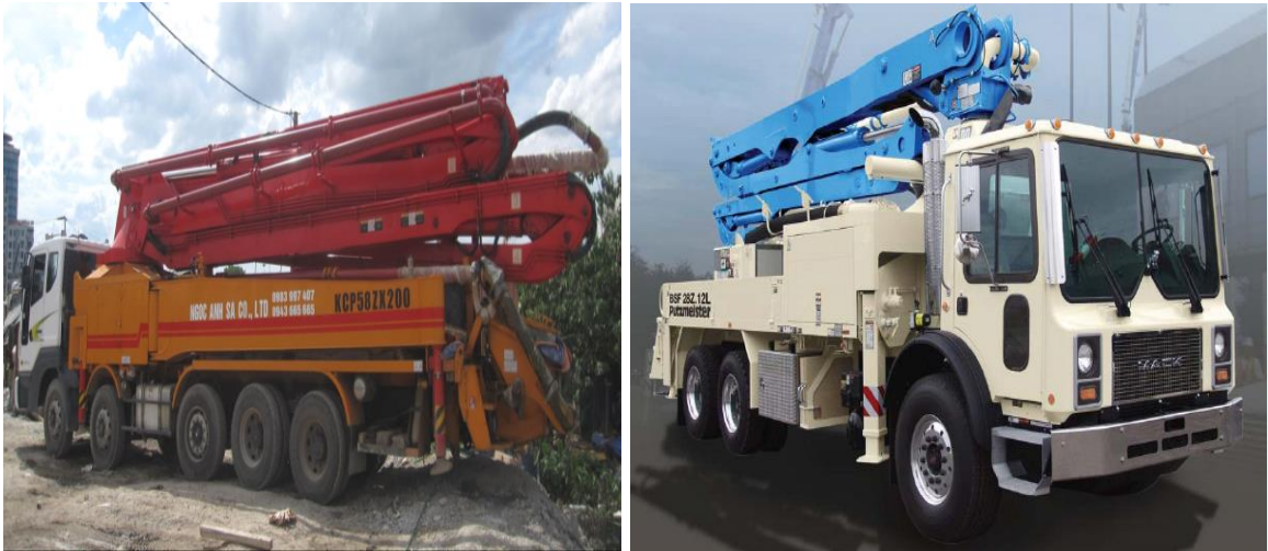
Hình 1.11. Xe bơm bê tông có tầm với cần từ 25 đến 68m
