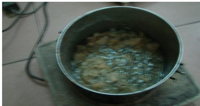
Hình 3.8. Quá trình đun chitin trong NaOH 40%
