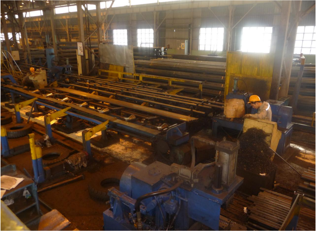
Hình 2.26. Công đoạn doa đầu ống
